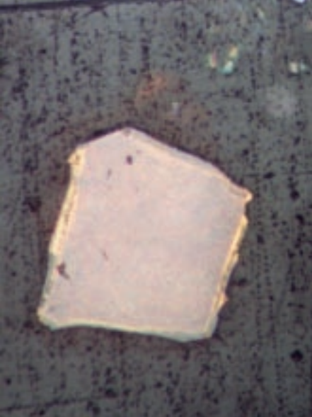
2 Кайма нового золота вокруг остаточного первичного золота. Фото в отраженном свете, поле зрения по горизонтали — 2,5 мм
